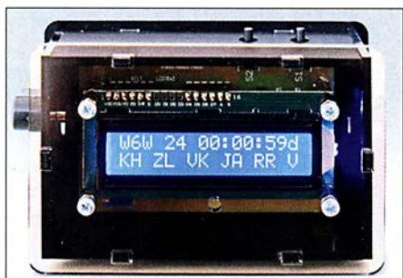
Bild 1: Die Frontseite des Gehäuses ist mit einer durchsichtigen Plexiglasscheibe abgedeckt. Fotos: DF1SD
