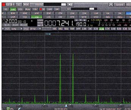
Bild 28: Das entsprechende Messergebnis bei P_e = 2 \cdot (-40 \text{ dBm}) zeigt \Delta IM_3 = 68 \text{ dB} und IP_3 = -6 \text{ dBm} .
