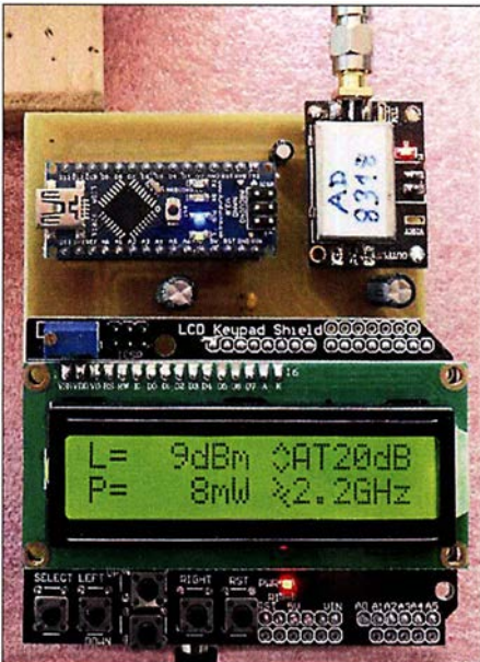
Bild 1: Aufbau der drei Module des Pegelmessers auf der Grundplatte Foto: DC5ZM
