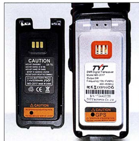
Bild 3: Lithium-Ionen-Akkumulator und Geräte rückseite mit Rastmechanismus
