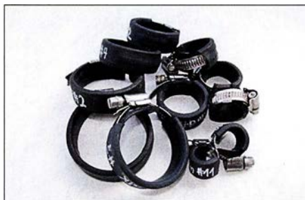
Bild 38: Schellensatz zur Sicherung des Schiebemastes gegen Zusammenrutschen
