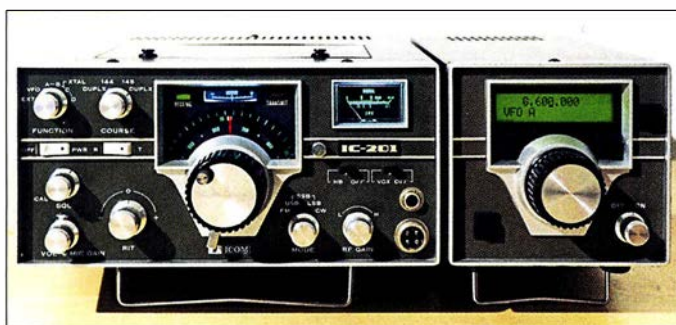
Bild 1: 2-m-Allmode-Transceiver IC-201 mit selbst gebautem externem Digital-VFO
