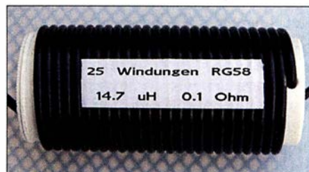
Bild 2: Koaxial-Balun auf einem 50-mm-Installationsrohr
