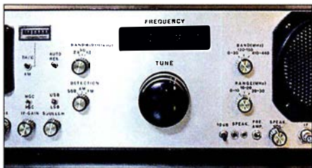
Bild 16: Analoger KW-Empfänger 0,1 MHz bis 30 MHz ohne Preselektor am Eingang und mit einem IP_3 = +26 dBm
