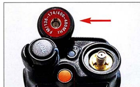
Bild 2: Oberseite mit SMA-Buchse, links oben die von unten gesehene Duobandantenne
