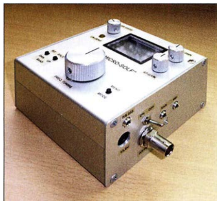
Blick auf eines der beiden Muster des kompakten 8-Band-QRP-Transceivers Micro-Solf von DK1HE Fotos: DK3RED
