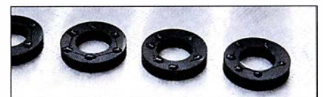
Bild 6: Vorbereitung zum Aufkleben – Ringkerne mit einigen Klebertropfen
