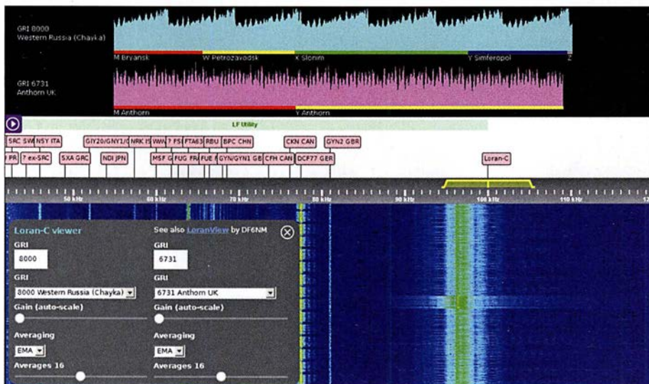
Bild 11: Visualisierung der LORAN- (Long Range Navigation) Signale aus Chayka im Westen Russlands (blau) und aus Anthon, Großbritannien (rot), empfangen auf 100 kHz, Ausschnitt
